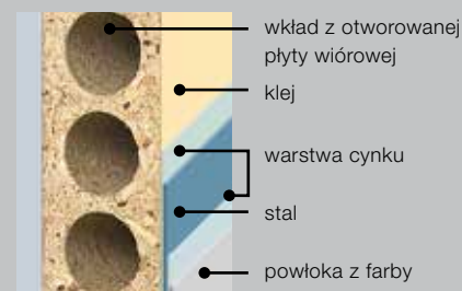
Wkład z otworowanej płyty wiórowej (standardowo)
