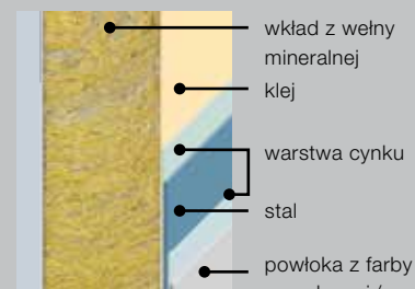
Wkład z wełny mineralnej (opcjonalnie) poprawia izolacyjność cieplną
