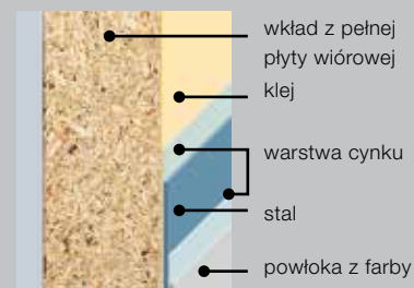
Wkład z pełnej płyty wiórowej (opcjonalnie) poprawia izolacyjność akustyczną
