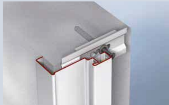
Profil 1 ościeżnicy kątowej przykręcić do konstrukcji ściany szkieletowej
