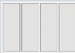
Wzór 440 Wypełnienie mocowane od wewnątrz wykonane z rozciąganej kratki
